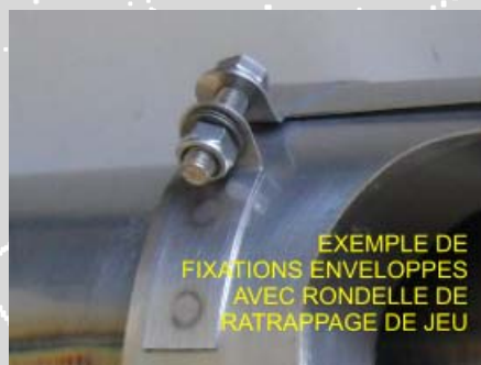
COLLECTEUR ZAPMO0100 INSTALLÉ SUR DR400/120
